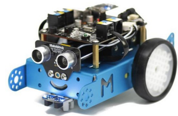
Robot mBot avec modules ultrasons et suiveur de ligne
